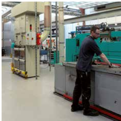
DS 64400 (tandem) med fickfilter, dammklass H
