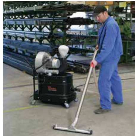
R01 S 015 dammexpl. vid lagerrensning
