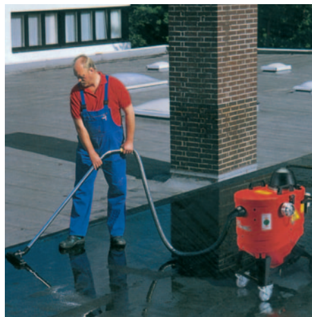
WSP 2000 in Feuerwehr-Ausführung (Storz-Kupplung)
