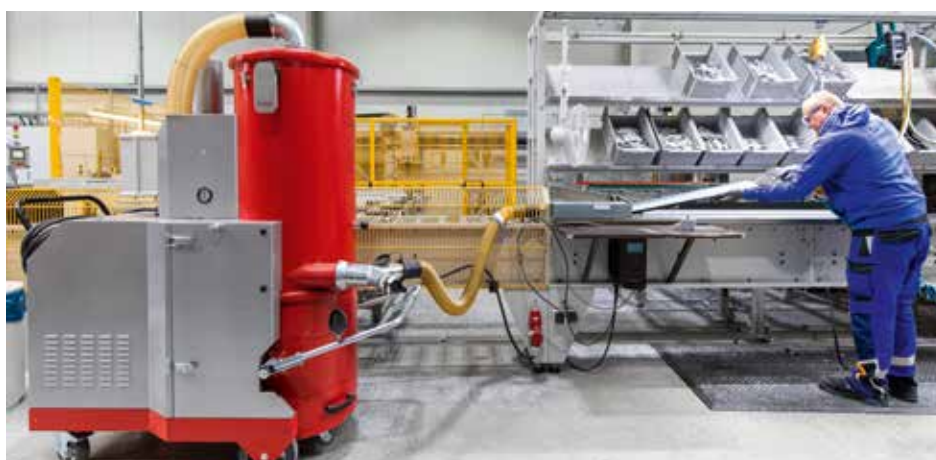
Odsysanie pyłu aluminiowego podczas obróbki metali
