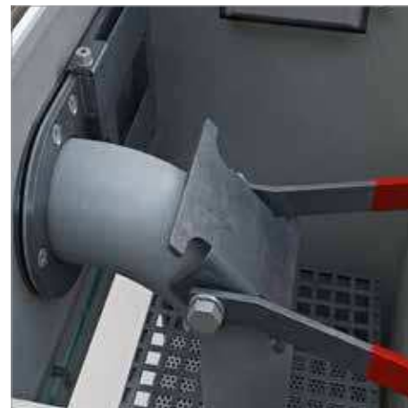
Veiligheidsklep verhindert zuigen zonder vloeistofreservoir
