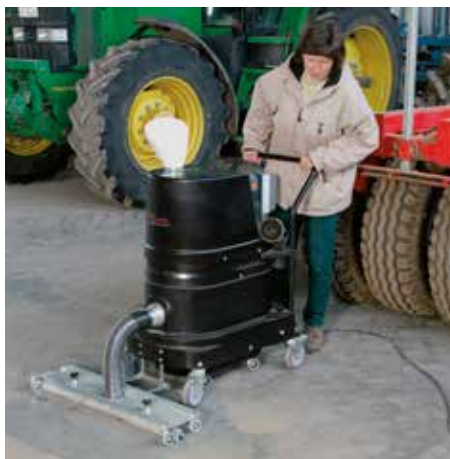
R01 R022 pour zones à poussières explosives avec dispositif d'aspiration au sol dans l'industrie agricole
