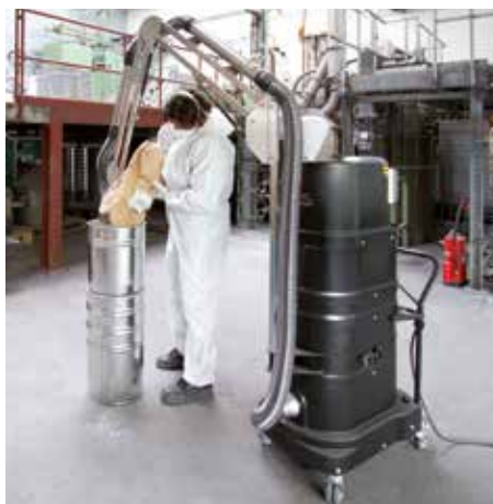
R01 R075 pour zones à poussières explosives, avec bras d'aspiration dans la production de plastique
