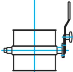
Clapet d'étranglement avec joint, partiellement sous vide
