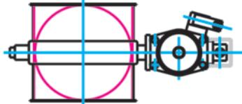
Clapet d'étranglement avec entraînement pneumatique, partiellement sous vide
