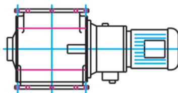
Écluse rotative électrique, partiellement sous vide
