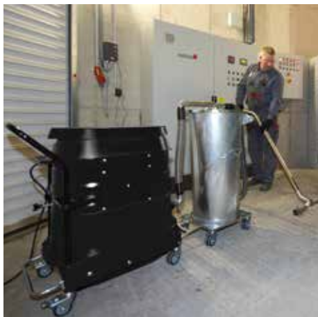
R01 A avec conteneur de pré-séparateur, 110 litres
