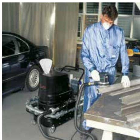
R01 R022 avec piège à étincelles, classe de poussière M
