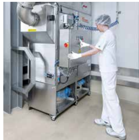
DS 64400 (tandem) avec filtre à cartouche, classe de poussière M
