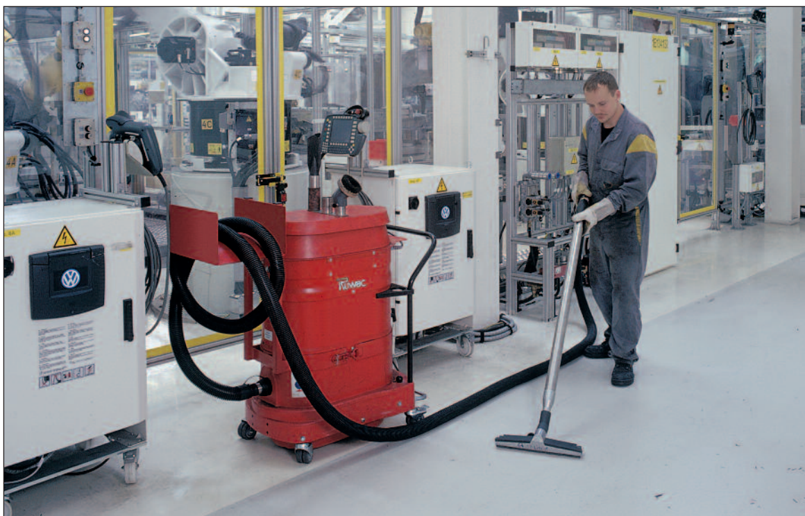
Figure 10, Aspiration, mise en oeuvre d'aspirateurs industriels
