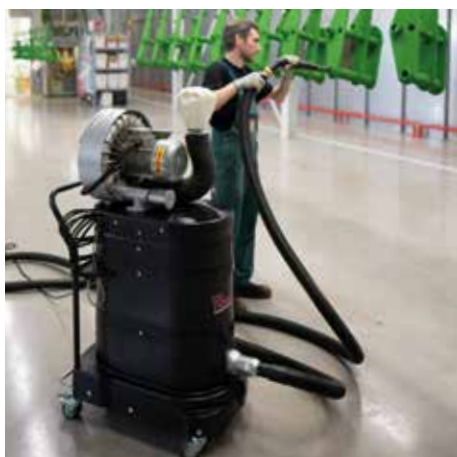
R01 S 022 pour zones à poussières explosives dans la technologie des surfaces (revêtement par poudre)
