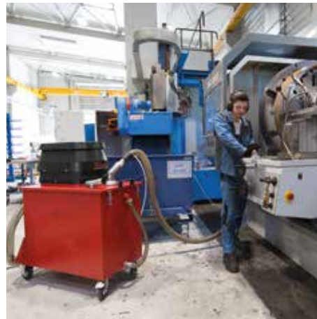
SPS 250-W36 en la elaboración de latón
