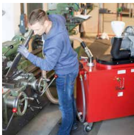
SPS 250 DA30, zone 22 en el tratamiento de magnesio
