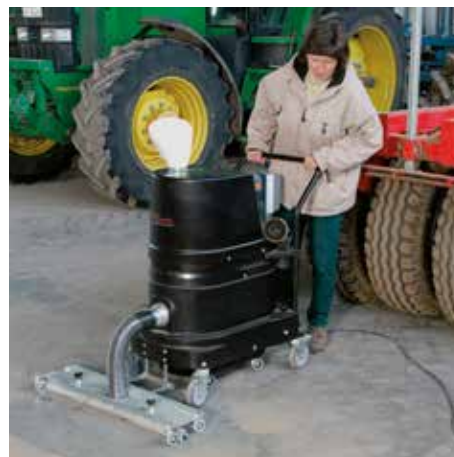
R01 R022 atm. expl. polvo con dispositivo para aspirar el suelo en la industria agraria
