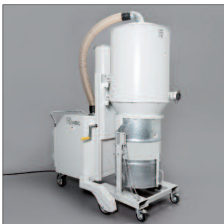
Recipiente de 200 litros con dispositivo basculante para montacargas
