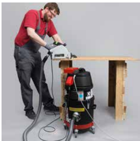
R18 A011 tsoon 22 koos elektrit juhtivast plastist mahutiga, mis on pistikupesaga automaatikaga, ühendatud töötlemismasinaga jaoks
