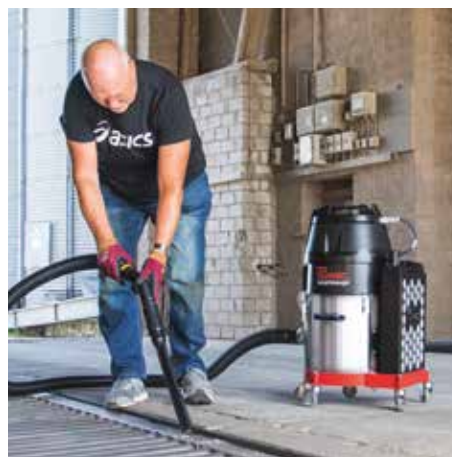
R18 D teraviljajääkide ACD imemine kitsastest vahedest
