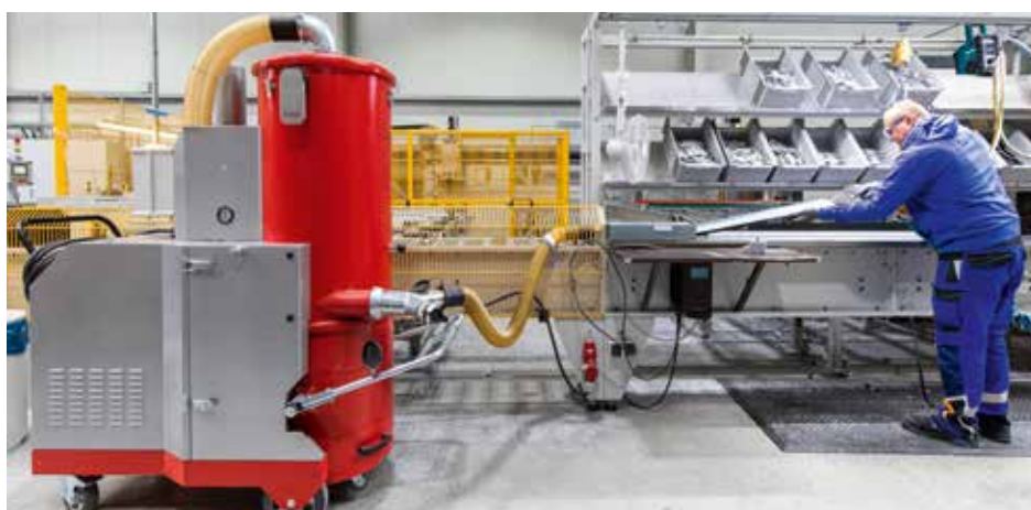
Alumiiniumitolmu imemine metallide töötlemisel
