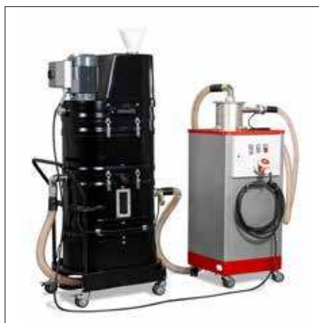
NA 35 koos kuivtolmu separaatoriga tüüp R26 Fikseeritud ühendus puudub
