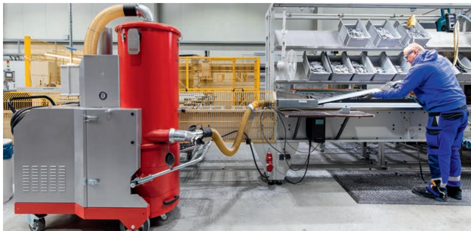
Aufsaugen von Aluminium-Staub in der Metallverarbeitung
