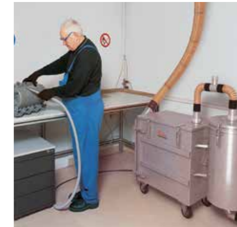
NA 250 Stahlblech mit Reststaubfilter in der Automobilzulieferproduktion
