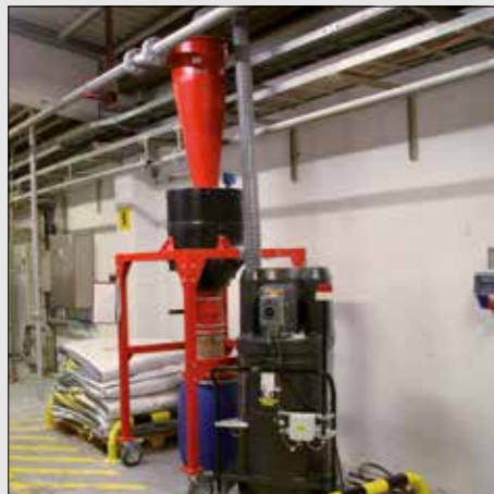
HGZ mit Silo als Puffer auf Standgestell
