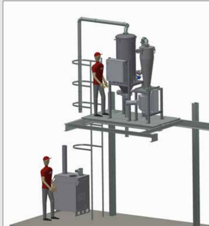
Absaugung von Strahlgut Konzept für Aufstellung auf engstem Raum bei ungünstigen Platzverhältnissen
