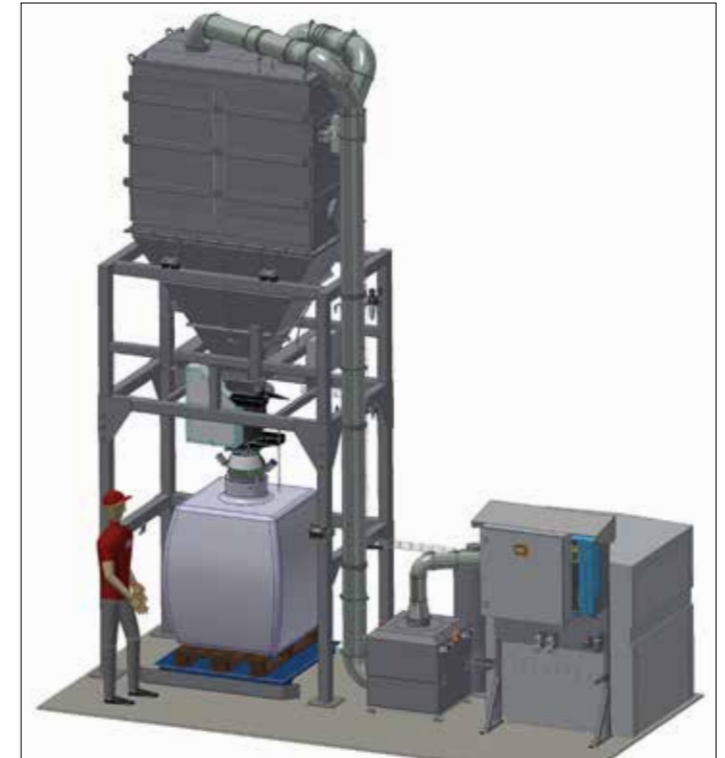
Absaugung von Titandioxid-Pulver Brückenbildendes, gesundheitsgefährdendes Sauggut, analoge Füllstandsmessung über Waage
