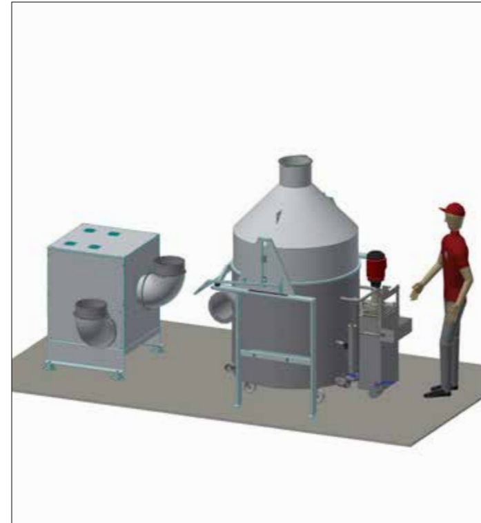
Absaugung von hochreinem Prozesswasser Automatische Weiterleitung des Wassers in eine Wiederaufbereitung
