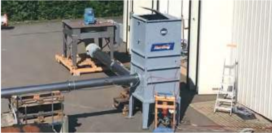
Bild 7: Flammenlose und rauchfreie Druckentlastung mit dem Herding Sinterlamellenfilter
