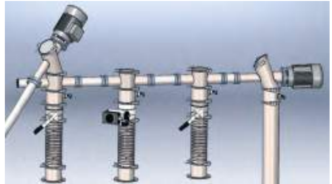
Die Mehrstellenbeschickungsanlage Typ PM eignet sich zur Beschickung einer Reihe von Maschinen
