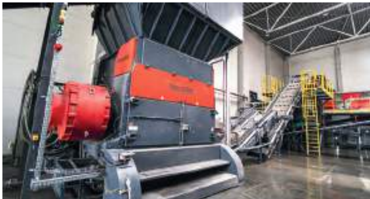
Der VEZ 2500 TV mit einem Torque-Antrieb übernimmt die Vorzerkleinerung. Das Material wird über ein angeschlossenes Förderband zum nächsten Prozessschritt transportiert
