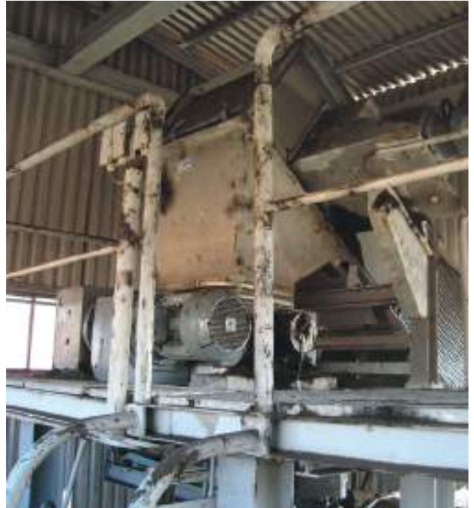
Im Probenaufbereitungsgebäude: Übergabe zwischen Steilförderer und Zerkleinerungsgerät (Stufe 1)
