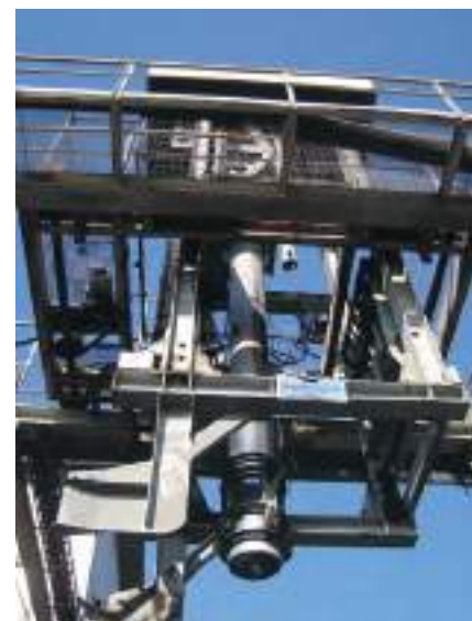
Probenehmer bestehend aus Bohrschnecke mit Säuberungsschaber, Fahrwerk und Hubwerk
