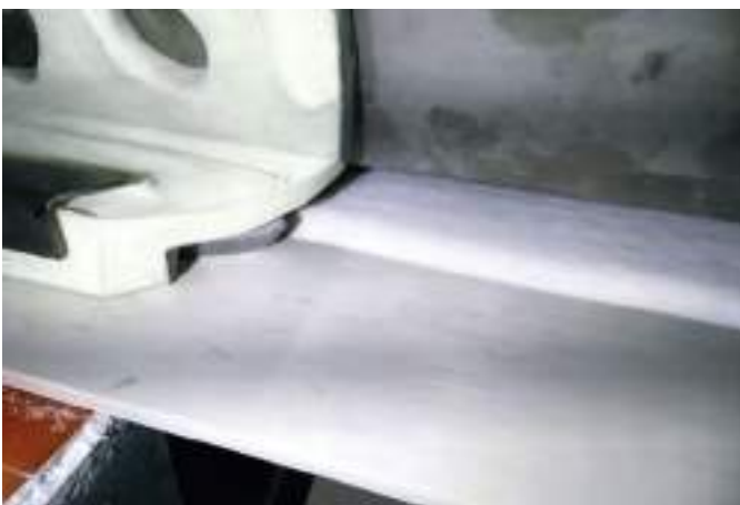
Der AirScrape in Aktion in der Zuckerindustrie. Am Ende der Übergabestelle schieben die Lamellen den vom Luftstrom zurückgehaltenen Zuckerstaub sauber zurück auf das Band. Die Umgebung bleibt sauber – und ohne Staub-Ex-Risiko
