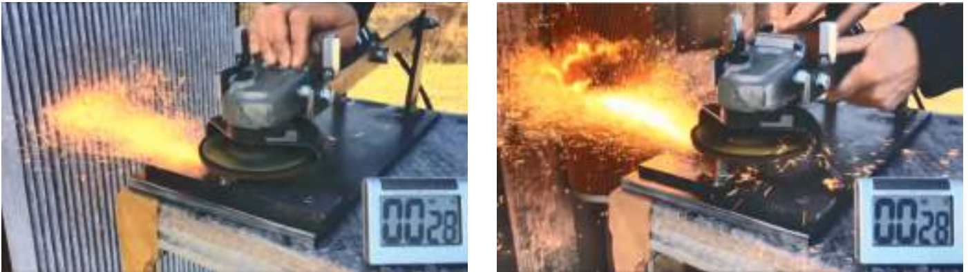
Bild 4: Entzündbarkeit: Herding Sinterlamellenfilter im Vergleich mit Patronenfilter
