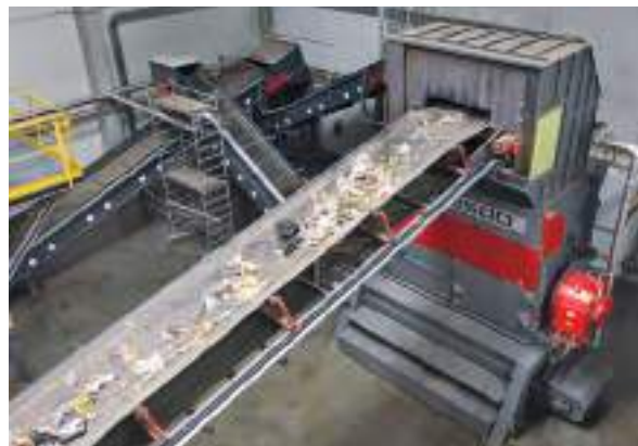
Der VEZ 2500 TT zerkleinert die anspruchsvollen Materialien zu homogenem Output, das als Ersatzbrennstoff eingesetzt wird
