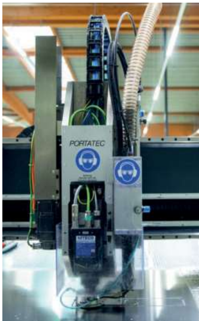
Effizient und sauber: Die Absaugung erfolgt direkt an der Entstehungsstelle der Späne.
