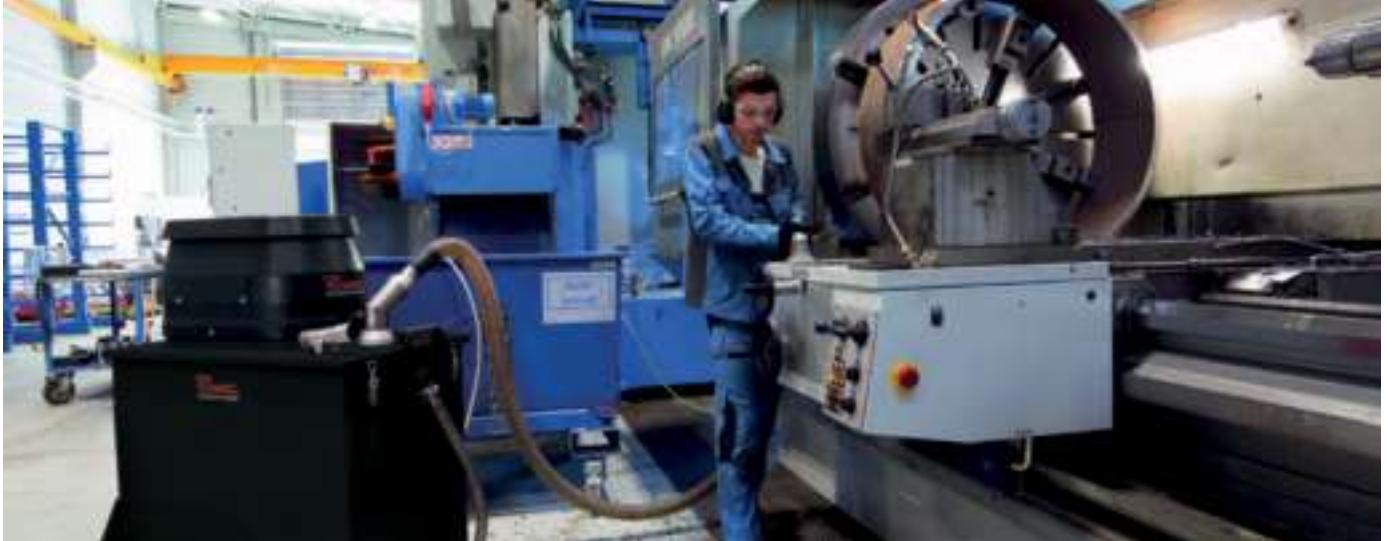
Alternative zum R01: Der Spänesauger SPS 250 eignet sich für die getrennte Entsorgung größerer Mengen von Spänen und Kühlschmierstoffen.
