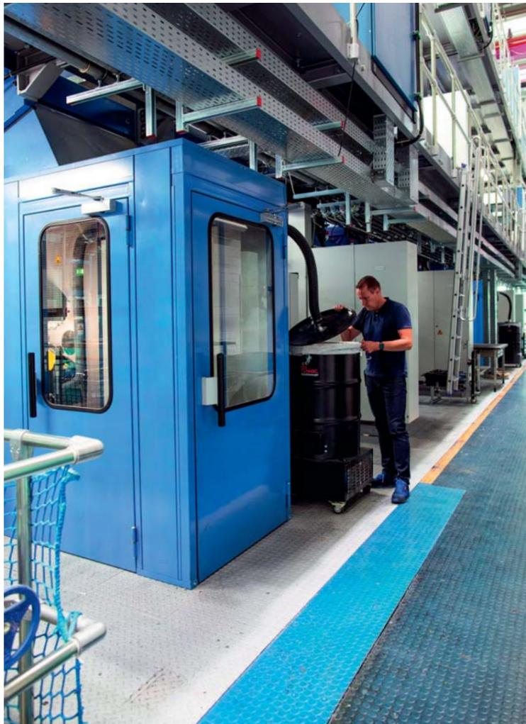
Diese Sauger hat der Hersteller mit den Druckmaschinen angeliefert, und sie sind steuerungstechnisch in den Produktionsablauf integriert: Sobald eine Maschine anläuft, starten die Sauger automatisch und sorgen für eine permanente Absaugung.
