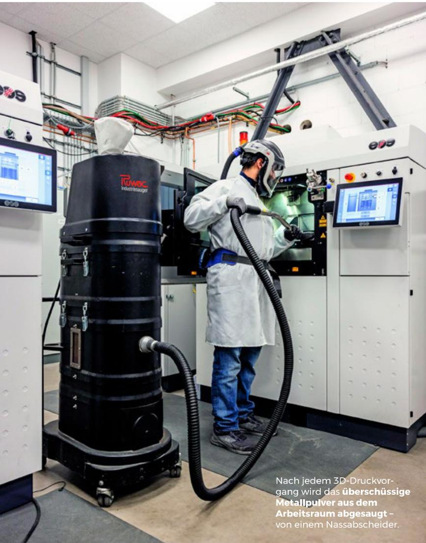
Nach jedem 3D-Druckvorgang wird das überschüssige Metallpulver aus dem Arbeitsraum abgesaugt – von einem Nassabscheider.
