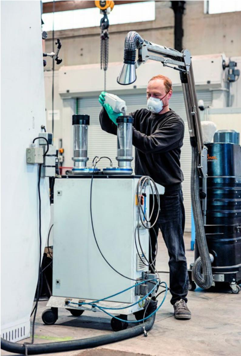
Beim Umfüllen, Abfüllen und Sieben des wertvollen Metallpulvers kommt **der Absaugarm des DS 1750 zum Einsatz.**
