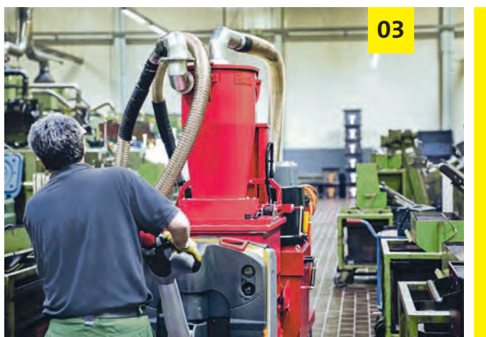
03 Der „Putzer“ – so heißt der Mitarbeiter, der die Absauganlage bedient – verfährt die neue mobile Absaugstation mit einem Elektro-Deichselstapler von Maschine zu Maschine
