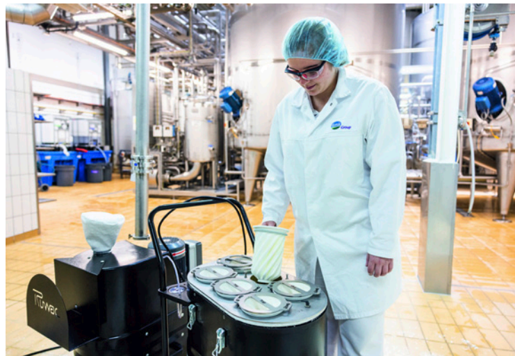
Die Filter lassen sich einfach entnehmen und im Autoklaven reinigen. Rechts: Die gewendelte Form der Filterelemente ist ungewöhnlich, aber hoch wirksam.
